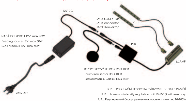
SCHEMA ZAPOJENÍ BEZDOTYKOVÉHO SENZORU S REGULACÍ SVÍTIVOSTI Connection diagram for touch-free sensor with luminous intensity regulation Схема подключения бесконтактного датчика, с регулировкой яркости
